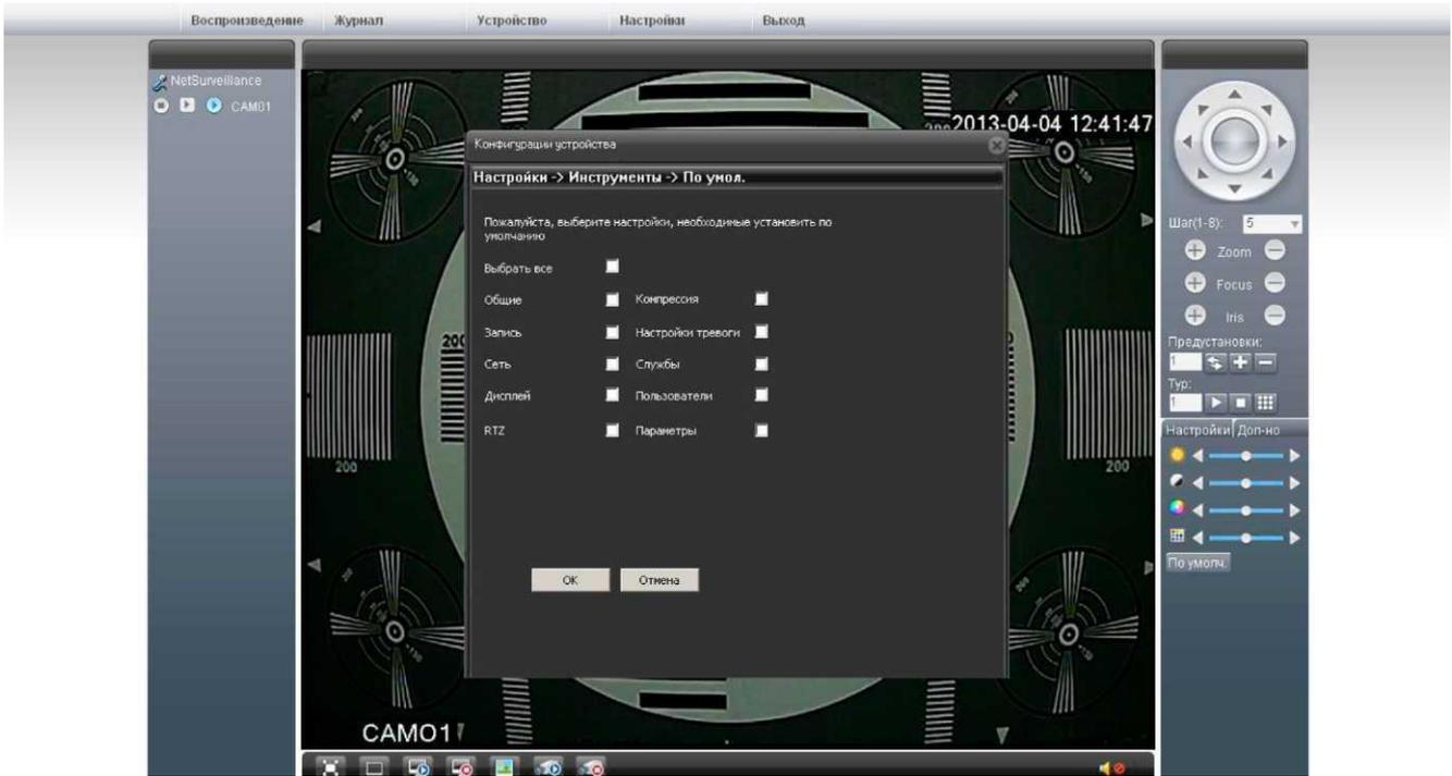
Раздел позволяет сбросить настройки камеры на заводские. Возможно сбросить как все настройки, так и выбрать, какой раздел будет сброшен.
