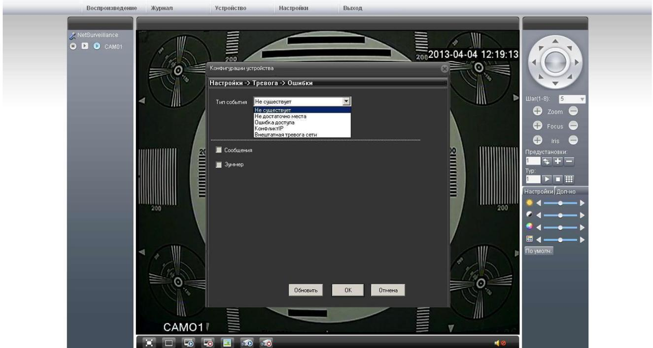
Раздел позволяет настроить режим сбора и анализа шибок камеры. При обнаружении ошибки камера выполнит установленное действие.
