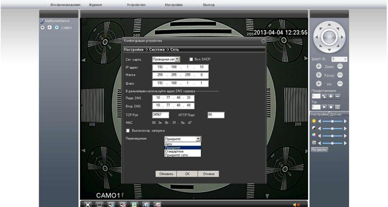
Раздел позволяет настроить параметры камеры для возможности доступа на неё из различных мест. Параметры возможно задать вручную, либо автоматически, включив DHCP (функция DHCP предварительно должна быть настроена).
