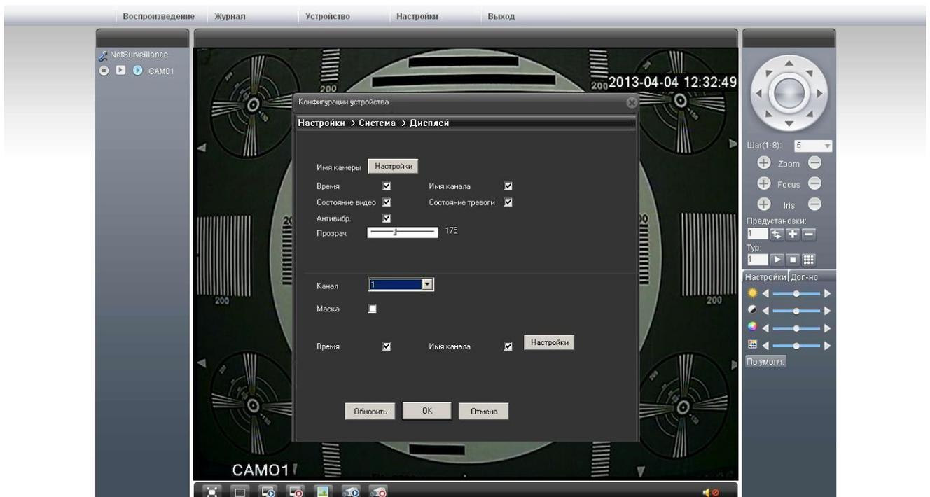
Раздел позволяет настроить параметры, отображаемые на видеопотоке: имя канала, состояние тревоги, состояние видео, имя камеры, время, антивибрацию, прозрачность меню, маски областей и их расположение на экране.
